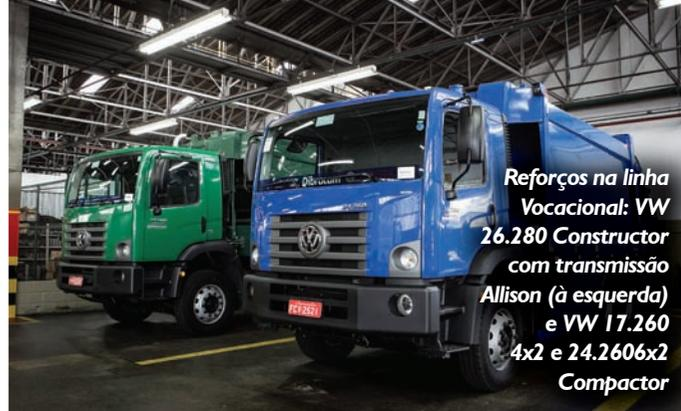
Reforços na linha Vocacional: VW 26.280 Constructor com transmissão Allison (à esquerda) e VW 17.260 4x2 e 24.260x2 Compactor
