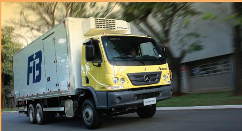
de entreeixos (3.700 e 4.400 mm), o Ac-celo 1316 6x2 permite a montagem de carroçarias de até 8 metros, a maior do mercado, segundo a fabricante.
