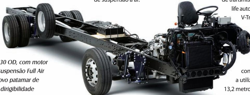
Chassi 17.230 OD, com motor dianteiro: suspensão Full Air introduz novo patamar de conforto e dirigibilidade
