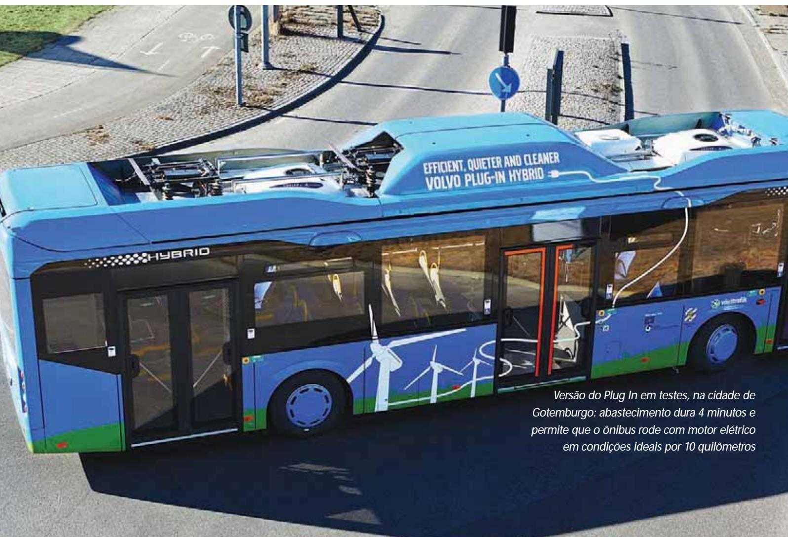
*Versão do Plug In em testes, na cidade de Gotemburgo: abastecimento dura 4 minutos e permite que o ônibus rode com motor elétrico em condições ideais por 10 quilômetros*
