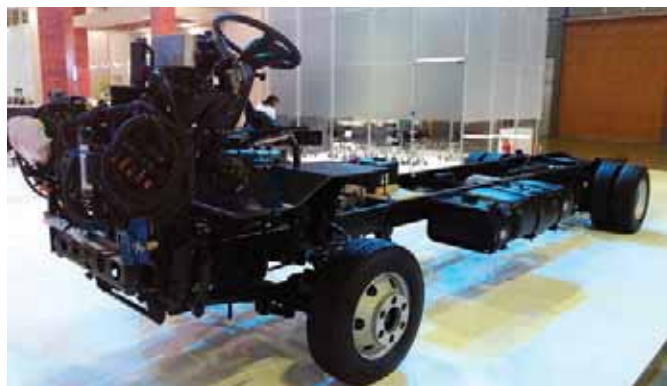
O chassi 9.160 ODS, com suspensão pneumática traseira opcional, e a versão 17.260 ODS, com suspensão integral, também opcional, foram as novidades apresentadas pela MAN/Volksbus
