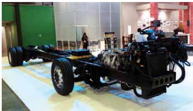
O chassi 9.160 ODS, com suspensão pneumática traseira opcional, e a versão 17.260 ODS, com suspensão integral, também opcional, foram as novidades apresentadas pela MAN/Volksbus
